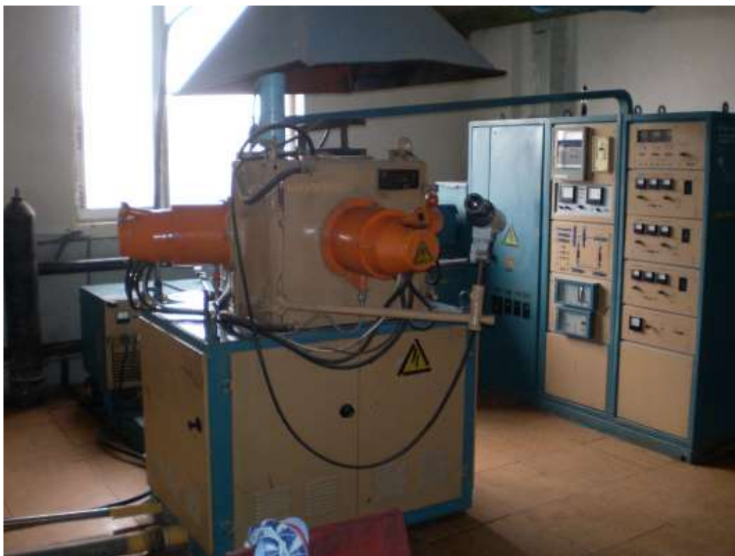
Участок БУЛАТ, наносящий различные слои на поверхность детали в целях повышения прочности и износостойкости.
